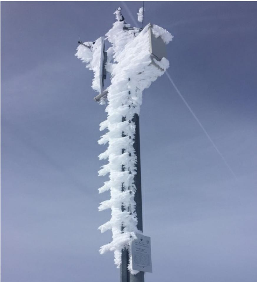
Suite aux conditions météorologiques de la semaine passée, plusieurs stations de mesures étaient givrées toute cette semaine. Au sommet de La Para (2540 m, Château d'Oex, VD), la vitesse du vent n'a par exemple pas pu être mesurée (photo: O. Roch, 18.02.2016).
