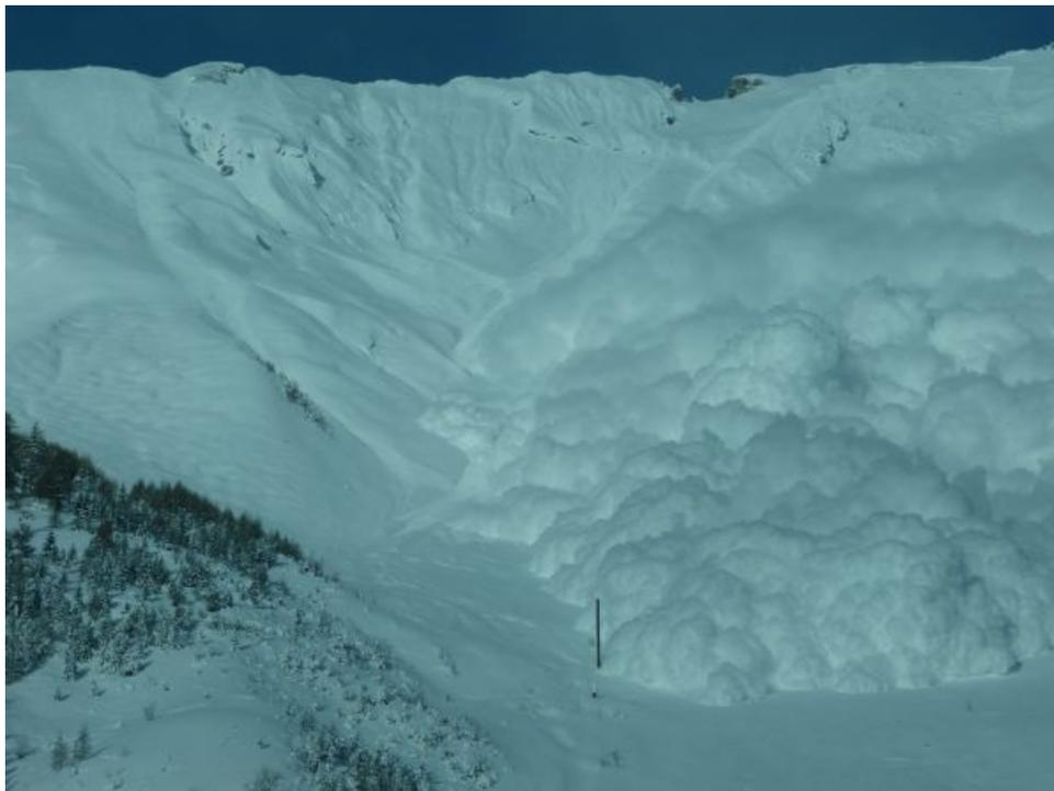
Photo 7: Avalanche déclenchée au moyen d'explosifs à des fins de recherche sur le terrain de test du SLF dans la vallée de la Sionne, Arbaz, VS. Le mât de mesure a une hauteur de 19 m (photo: SLF, 18.01.2016).
