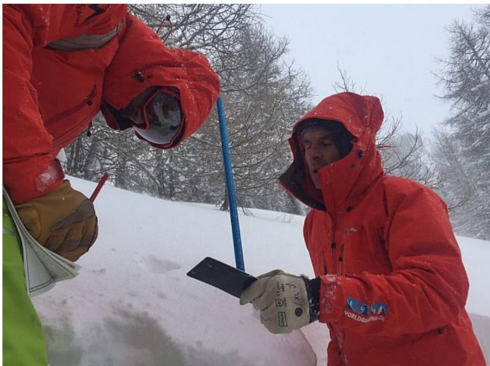
Photo 5: Observateurs du SLF lors du relevé de profils de neige. Le bloc glissant s'est brisé dans la neige fraîche sous un niveau de charge 2 (lorsqu'un skieur marche précautionneusement sur le bloc). Pente exposée au nord-ouest à 2000 m (photo et vidéo: J.-L. Lugon, 11.01.2016).
