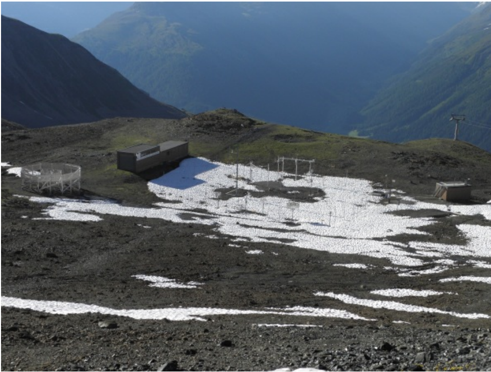
Abb. 4: Kurz vor dem Ausapern: Das Versuchsfeld auf dem Weissfluhjoch (2540 m), am Donnerstag, 01.07. morgens um 8 Uhr. "Ausgeapert" bedeutet, dass mehr als 50% der Messfeldfläche schneefrei sein müssen (Foto: SLF/Th. Stucki). Am Morgen des 2. Juli war dies erfüllt.
