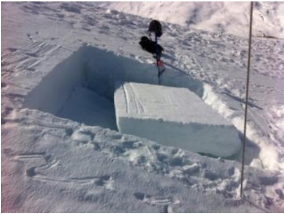
Abb. 8: Rutschblocktest und Schneeprofil an einem Westhang auf 2700 m (Corvatsch, Silvaplana/GR; Foto: U. Furrer, 29.04.2015). Die Schneedeckenoberfläche war am Morgen hart gefroren. Abgesehen von den oberflächennahen Schichten war die Schneedecke komplett 0 °C-isotherm. Der Rutschblock brach als ganzer Block bei mittlerer Belastungsstufe – normalerweise ein Zeichen für eine eher instabile Schneedecke. Allerdings ist bei einer so hart gefrorenen Oberfläche, welche vor dem Test gesägt wird, das Rutschblockergebnis nur schwierig zu interpretieren (Profil als PDF).
