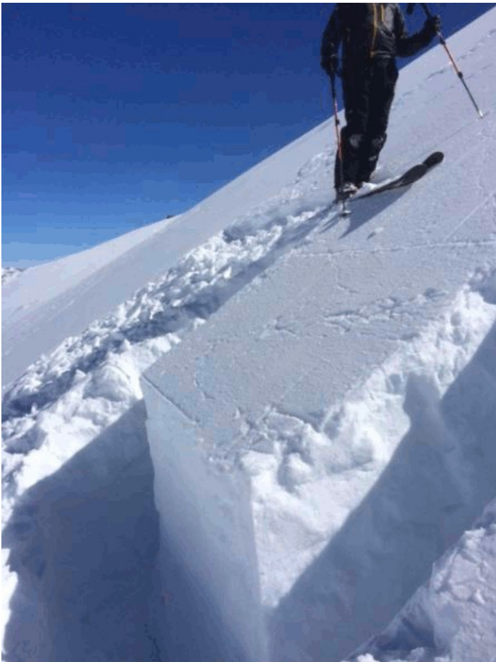
Rutschblocktest bei der Fuorcla da Puozas (Vals, GR) an einem Nordhang auf 2735 m (Fotos: H. Tönz, 28.03.2015).
