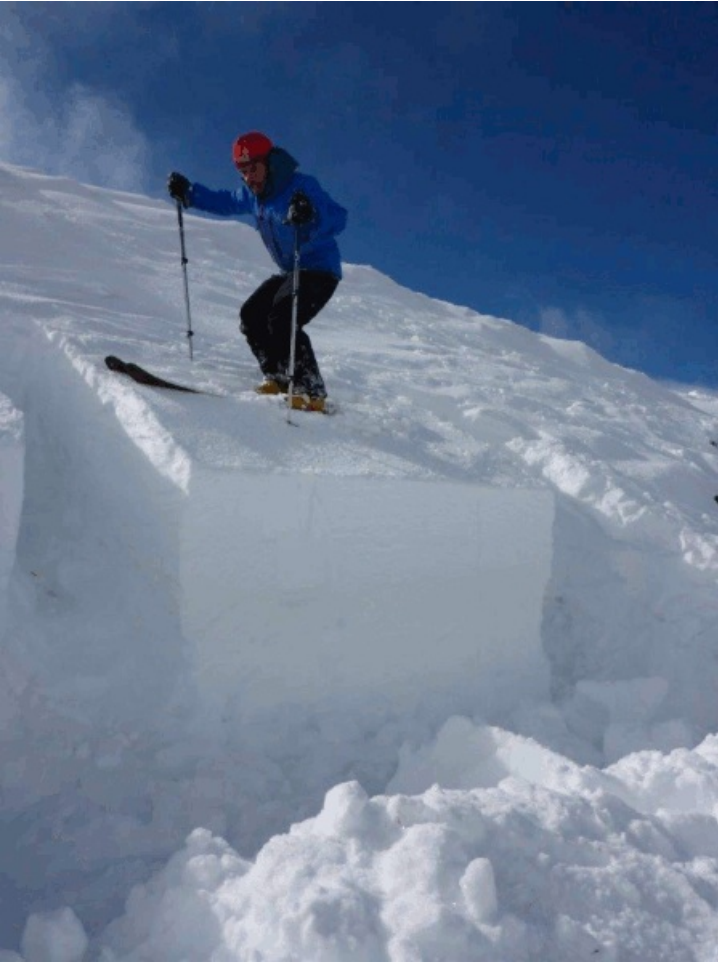
Rutschlocktest anlässlich einer Schneeprofilaufnahme an einem Nordhang auf knapp 2000 m am Gamserrugg (Grabs, SG). Während sich beim blossen belasten mit dem Körpergewicht noch nichts bewegte, brach der Block beim ersten Sprung mit Ski von oben in drei verschiedenen Schichten (pinke Pfeile) (Foto: R. Diener, 28.02.2015).
