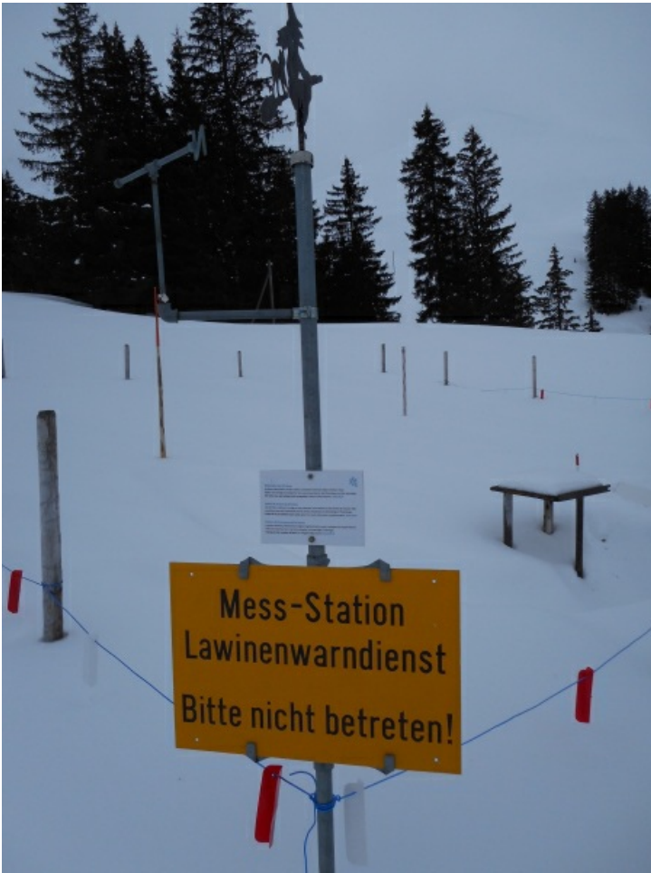
Das SLF-Messfeld bei der Underi Gantrischhütte (1510 m, Rüschegg, BE). Das SLF betreibt gut 100 solcher Stationen, an denen täglich manuelle Messungen durchgeführt werden. Die Daten dienen nebst der Lawinewarnung u.a. auch der Schneeklimatologie und der Schneehydrologie (Foto: R. Wellig, 01.03.2015)
