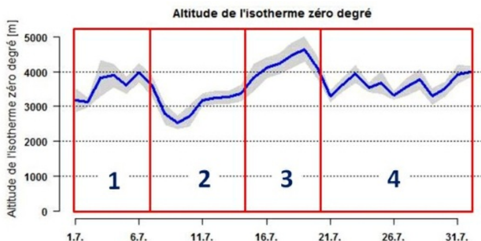
Figure 2: Evolution de l'isotherme zéro degré en juillet. Sauf pendant la brève période de forte chaleur (période 3), l'isotherme zéro degré se situait généralement entre 3000 et 4000 m. La situation de l'isotherme zéro degré a été calculée à partir des températures à la mi-journée de 11 stations automatiques du SLF et de MétéoSuisse.
