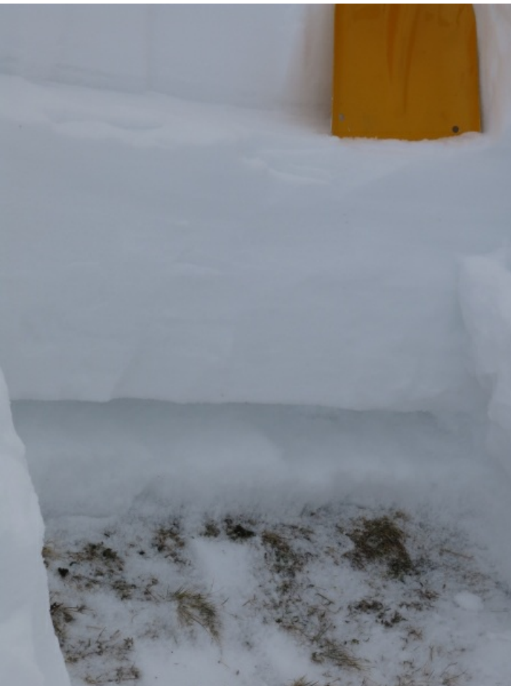
Bei einem Schneeprofil zeigte sich der schwache Altschnee am Plan Zenevrec oberhalb von St. Martin im zentralen Wallis. Die bodennahe Schicht bestand aus grobkörnigem, kantig aufgebautem Schnee. Darüber lagen teils härtere Schichten der Schneefälle seit dem 25. Dezember (Foto: G. Sanga, 18.01.2014).
