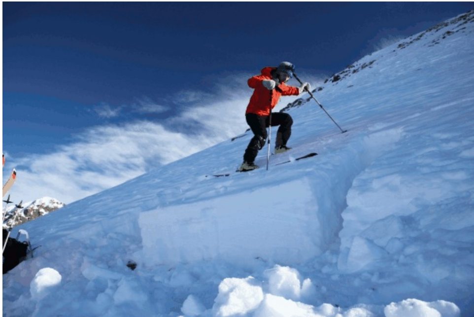
Abb. 8: Wer sucht der findet. In diesem Rutschblockversuch am Gfirorenhorn (Westhang, 32 Grad, 2520 m, kammnah) konnte eine alte Tribschneeansammlung beim Wippen (Stufe 3) als ganzer Block ausgelöst werden (Foto: SLF/F. Techel, 14.12.2013).
