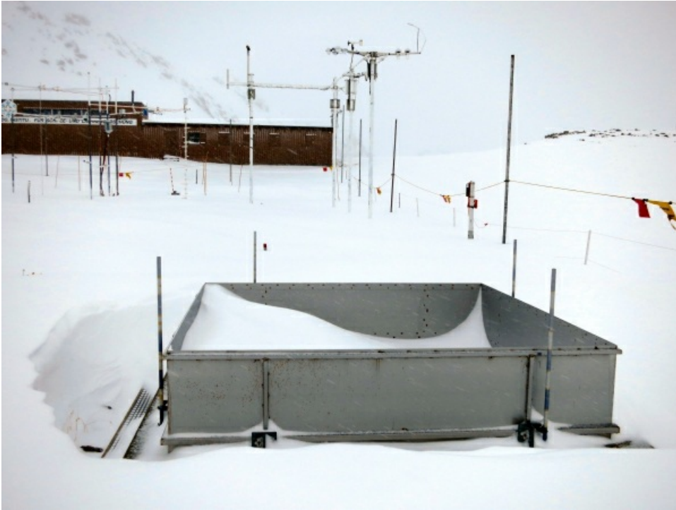
Das Versuchsfeld Weissfluhjoch im Frühwinterkleid. Im Vordergrund das Lysimeter, mit welchem der Wasserabfluss am Boden gemessen werden kann (Foto: SLF/N. Wever, 12.10.2013).
