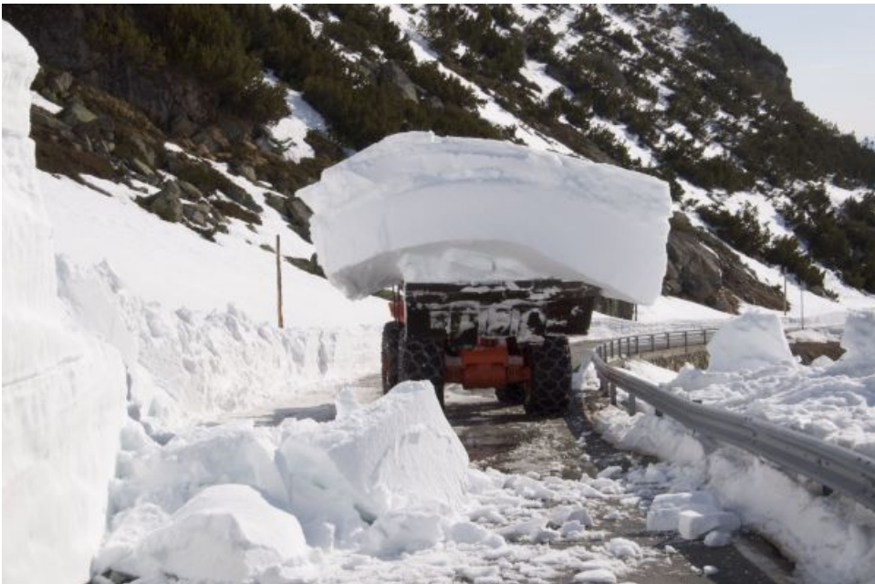
Der Schnee wird entsorgt. Ob durch Wärme, Lawinen oder den Pneuclader - es sind alle Mittel recht. Schneeräumung am Flüelapass (Susch, GR) (Foto: J. Rocco, 16.04.2013).
