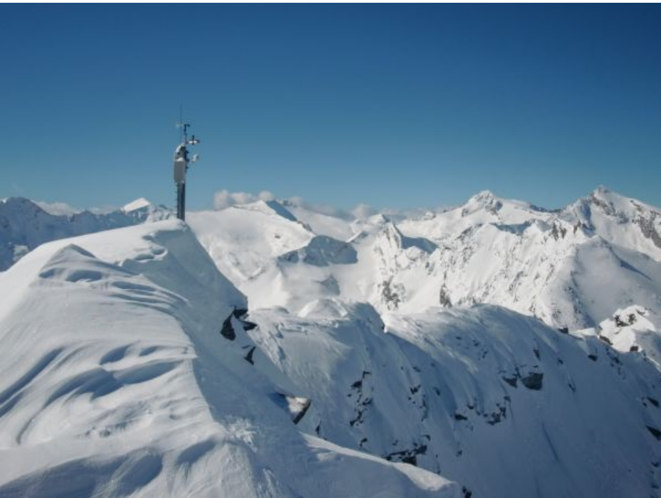
Ein fleissiger Mitarbeiter der Lawinendienste und der SLF-Lawinenwarnung. Diese Windstation auf dem Chälchalhorn liefert rund um die Uhr Daten zu Windstärke, Windrichtung und Temperatur (Foto: S. Bernhard, 19.03.2013).
