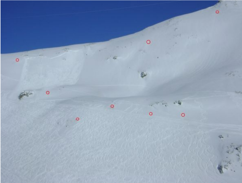
Zur Sicherung von Skipisten vor Lawinen werden durch die Pisten- und Rettungsdienste der Bergbahnen regelmässig Sicherheitsprengungen durchgeführt. Dieses Beispiel zeigt einen zu sichernden Bereich. An verschiedenen Orten wurde gesprengt (rote Kreise). Eine Lawine wurde ausgelöst. Als Stabilitätstest bedeutet das: Gefahrenstellen sind nur wenig verbreitet (Foto: V. Bettler, Montana, 16.02.2013).
