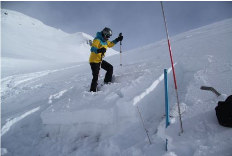
Rutschblocktest anlässlich eines IFKIS-Kurses für Beobachter und Sicherheitsverantwortliche in Davos. Der Rutschblock löst sich "beim Drauftreten" (Stufe 2) und gleitet unterhalb der Skis weg. Gut zu erkennen ist hier etwas dunkler die kantig aufgebaute Altschneeschiicht und darüber die dünne Neuschneeschiicht (Foto: SLF / L. Dürr).
