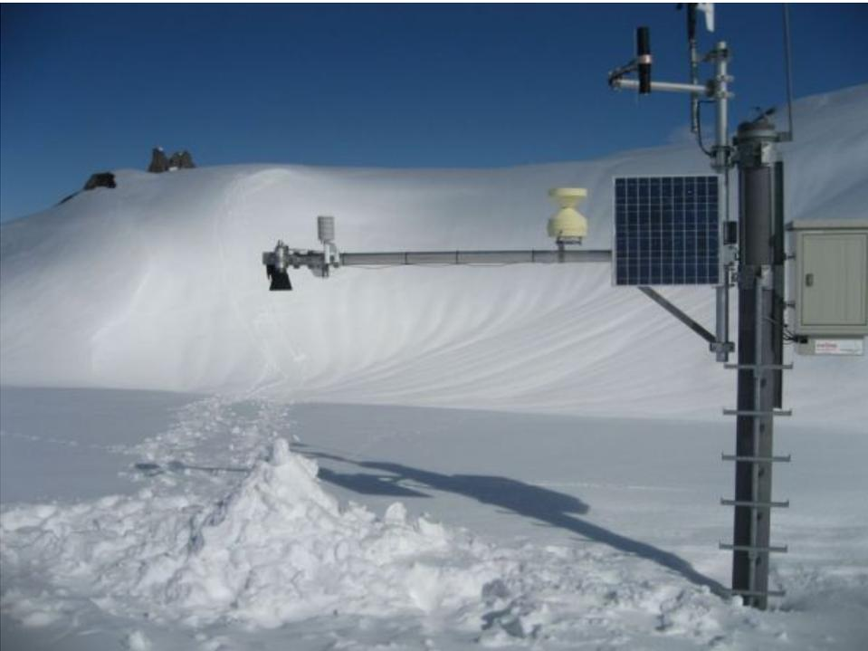
*Die bereits überdurchschnittliche Schneehöhe auf der IMIS-Station Rapperslauri (2083 m, Muotathal, SZ) genügte diesem Saboteur offensichtlich nicht. Der lokalen SLF-Beobachter konnte die fehlerhafte Messung wieder beheben (Foto: X. Holdener, 18.03.2012).*
