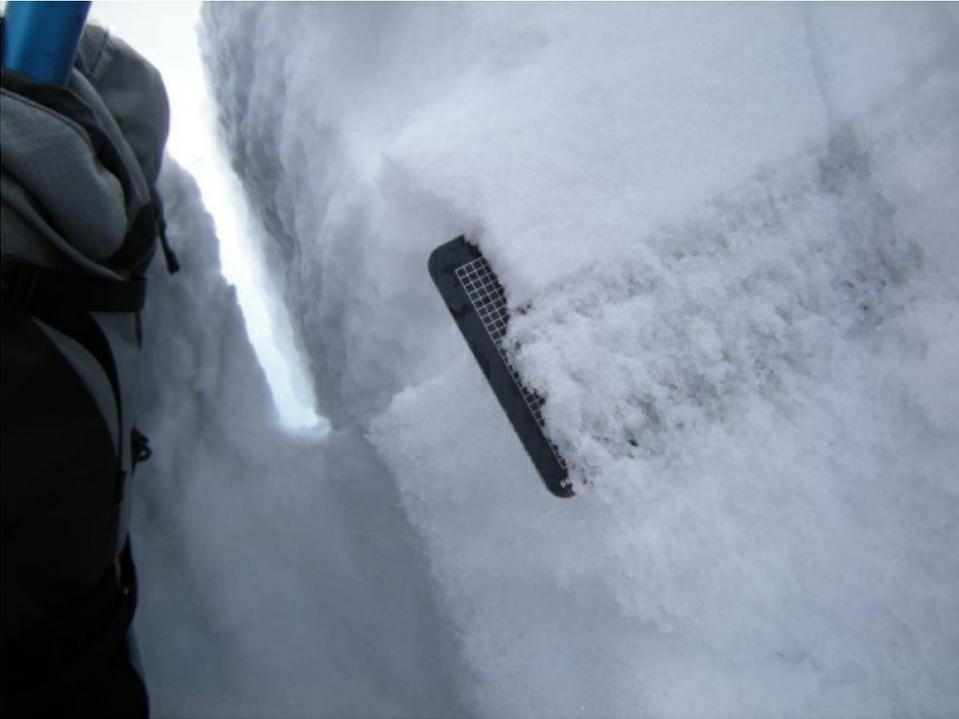
*Schneedeckenuntersuchung im mutmasslichen Auslösbereich einer Lawine (vgl. erstes Foto). Von Auge ist eine weiche, eingeschnete Schicht erkennbar (die Farbe des Rasters schimmert durch den Schnee). Wahrscheinlich ist diese Lawine oberflächlich angerissen und dann zusätzlich in tieferen Schichten gebrochen) (Foto: SLF/F. Techel).*
