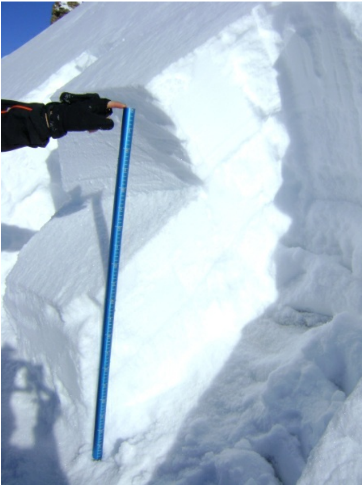
Le test de stabilité ECT (extended column test) résultat après 4 coups du poignet (Photo: V. Bettler, 08.02.2010).
