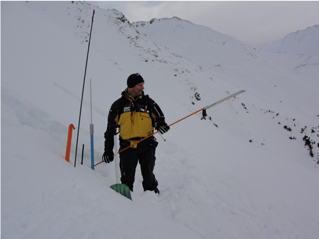
Schneeprofile oberhalb der Schmittner Alp im Landwassertal, GR. Der Rutschblockteste zeigte eine Auslösung der oberen Schneeschichten auf dem schwachen Schneedeckenfundament beim ersten Sprung mit Ski von oben (Foto: M. Balzer, 30.12.2009).
