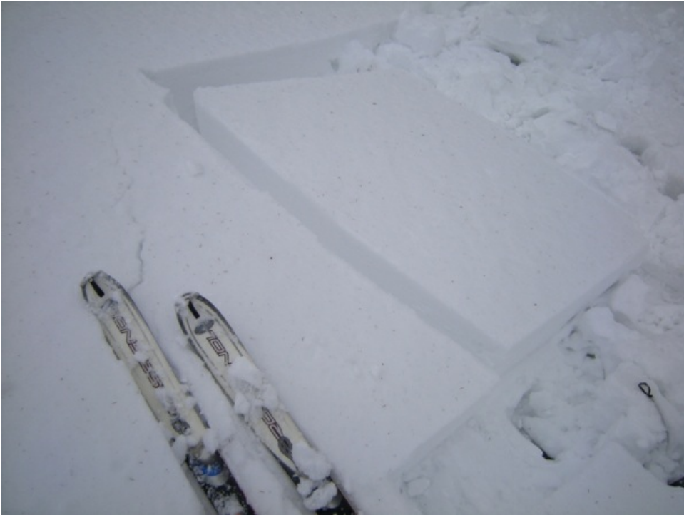
Die oberste Schicht frischen Tribschnees löste sich bei diesem Rutschblock an einem rund 30 Grad steilen Osthang auf 1500 m im Gantrischgebiet schon beim Annähern (Foto: F. Techel, 22.12.2009).
