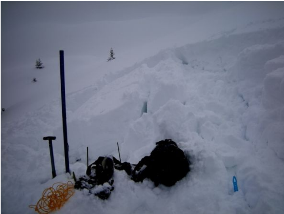
Bei heiklen Verhältnissen wird auch ein Rutschblockversuch zur Untersuchung der Schneedecke zum Risiko. Bei schlechter Sicht und heikler Lawinensituation ist es schwierig, einen geeigneten und doch möglichst ungefährlichen Ort zu finden. Dieser Rutschblock an einem Nordosthang auf rund 1800 m auf der Grimmli, Diemtigtal, BE glitt bereits ab bevor er belastet wurde. Ein eindeutiges Indiz für eine schwache Schneedecke (Foto: F. Techel, 11.02.2009).
