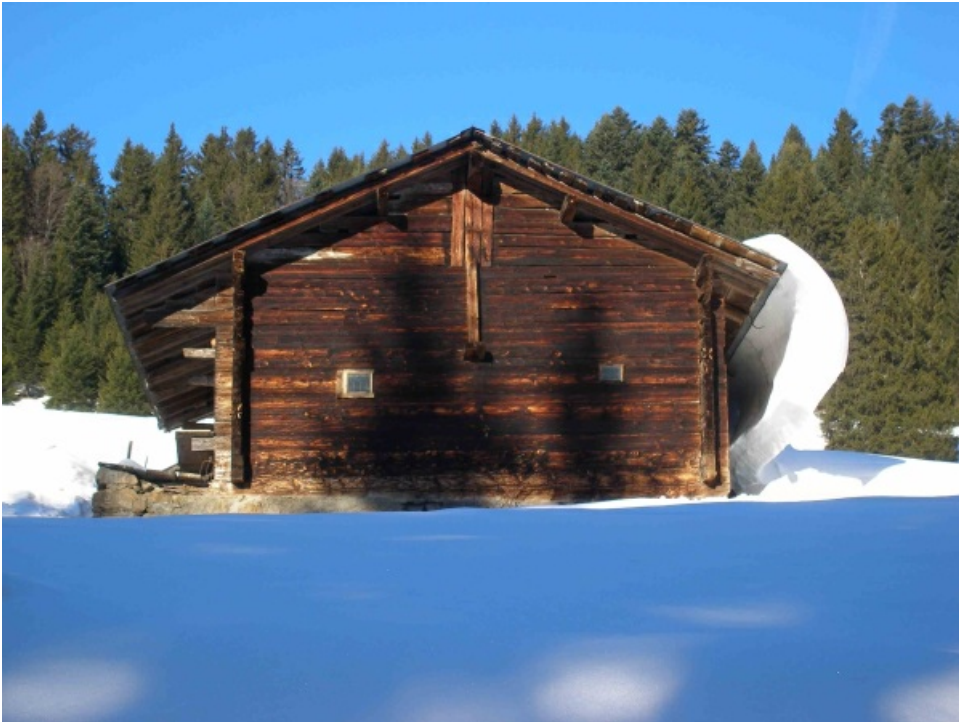
Eine mächtige Schneeschicht glitt langsam vom Dach. Wenn die Bewegung wie hier genügend langsam ist, verhält sich Schnee plastisch und hat eine recht hohe Festigkeit. Bei schneller Deformation dagegen hat Schnee eine deutlich geringere Festigkeit und bricht spröde. Col de la Croix, VD (Foto: SLF/M. Phillips, 25.12.2008).
