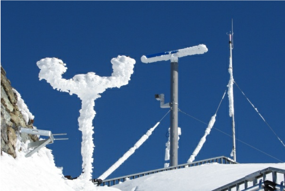
Verreifung der Meteosensoren inklusive Niederschlagsradar (blau) auf dem Gipfel des Kl. Matterhorns, 3883 m, Zermatt VS (Foto: G. Kappenberger, 13.04.2008).
