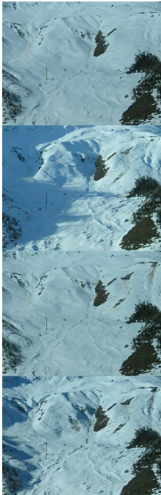
*Photos 6: Où sont les 3 différences? Sur chacune de ces photos, on peut déceler une nouvelle avalanche de glissement. Les images proviennent de la caméra du 'bunker' de l'ENA sur le champ d'expérimentation de la vallée de la Sionne, VS. Le mât métallique d'une hauteur de 20 m, que l'on peut voir sur ces photos, est situé à environ 1640 m sur une pente exposée au sud-est. Heures des prises de vue (de haut en bas): 28.01, 12h30; 28.01, 15h30; 29.01, 12h30; 29.01, 14h30.*
