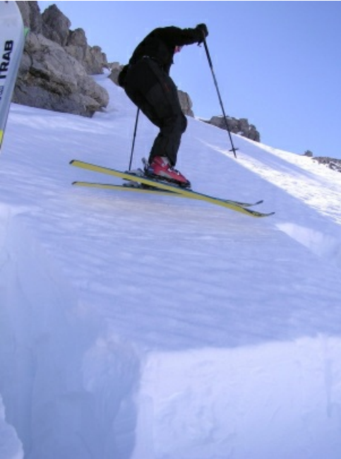
Und bist du nicht willig, so brauch ich Gewalt! Versuch einer Rutschblock-Auslösung in einem Nordwesthang auf 2700 m an der Weissfluh, Davos, GR (Foto: SLF/C.Pielmeier, 19.04.2007).
