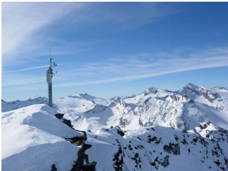
Photo 6: Les stations IMIS de mesure du vent sont installées sur des crêtes exposées. Elles mesurent la température et l'humidité de l'air ainsi que la vitesse et la direction du vent. Chilchalhorn, GR avec vue vers le Rheinwaldhorn, 3402 m, GR/TI (photo: C. Gansner, ENA, 16.02.2007).
