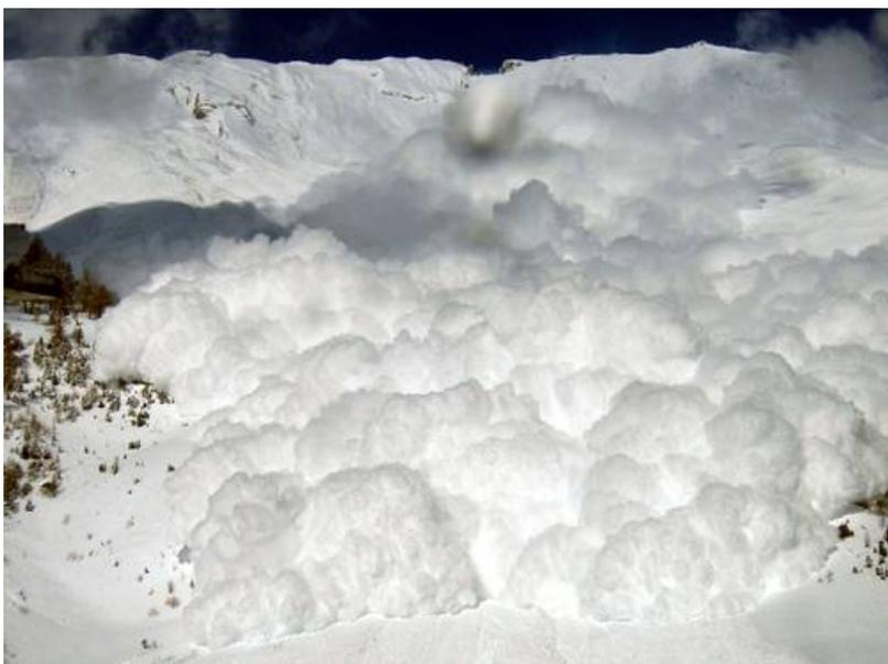
Abb. 14: Grosse gesprengte Lawine mit hohem Staubanteil und einer kräftigen Druckwelle im Versuchsgelände Vallée de la Sionne bei der Creta Besse ob Sion, VS, SE-Hang, auf rund 2700 m (Foto: SLF, 06.03.2006).
