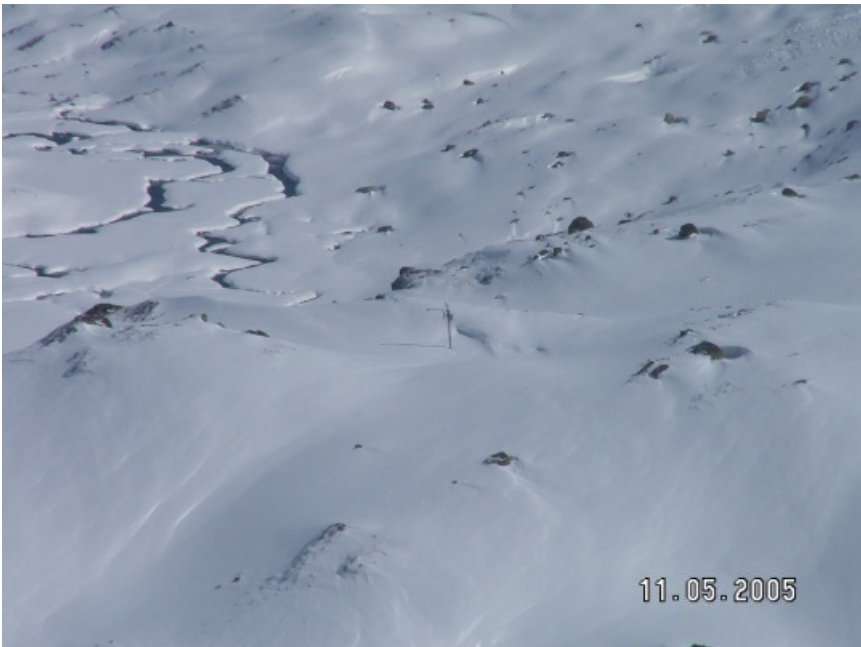
IMIS-Schneestation am Flüelapass, GR. Folgende Messwerte der Schneehöhe dieser Station auf 2390 m verdeutlichen den Schmelzprozess. 11. Mai: 159 cm; 17. Mai: 134 cm; 23. Mai: 123 cm; 31. Mai: 74 cm (Foto: SLF/T. Stucki, 11.05.2005).
