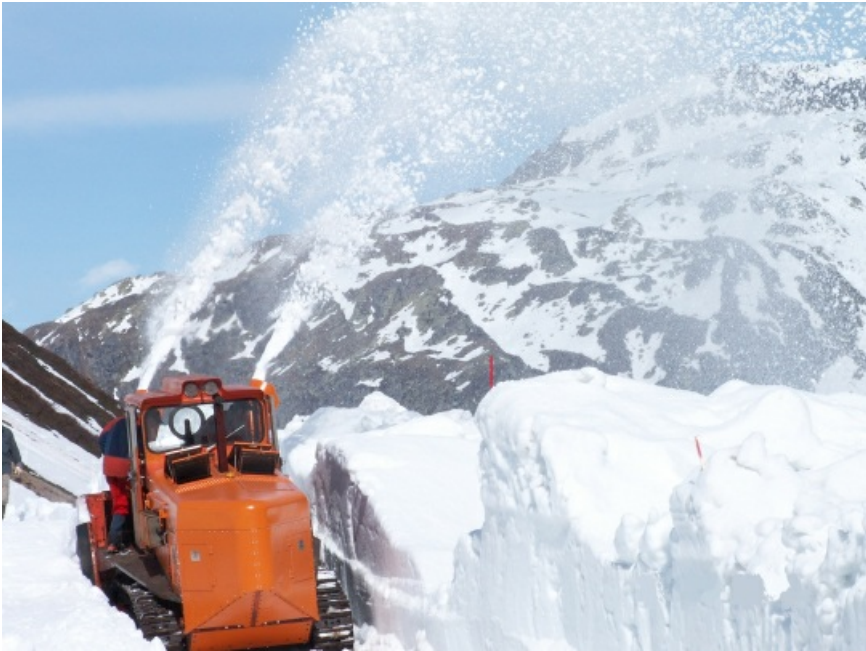
Alle Fräsen voll zu tun hatten die Schneeräumer am Furkapass. Die Passstrasse war bereits offen und hier wurde für die Dampfbahn das Trasse geräumt (Foto: SLF/B. Zweifel, 21.05.2005).
