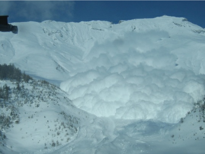
Künstlich ausgelöste Staublawine im SLF-Versuchsgelände Valle de la Sionne am Donnerstagvormittag, 17.02.2005, Sion, VS. Bild 3 von 3: Die Lawine erreicht die instrumentierten Masten im Lawinenzug. Dort sowie auch vom gegenüberliegenden Bunker aus werden die Drücke, Geschwindigkeiten und Dichten der Grosslawine gemessen.
