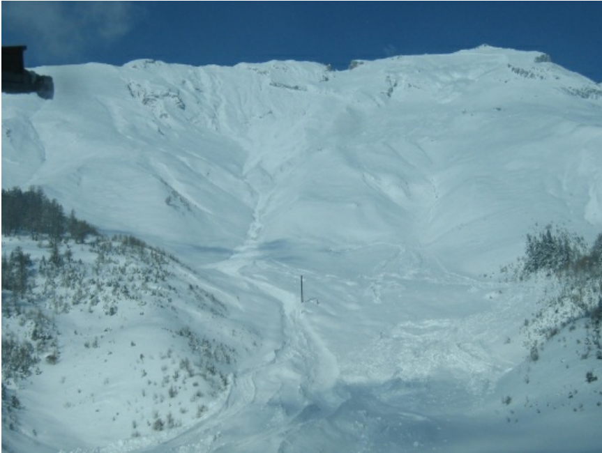
Künstlich ausgelöste Staublawine im SLF-Versuchsgelände Valle de la Sionne am Donnerstagvormittag, 17.02.2005, Sion, VS. Bild 1 von 3: Kammnah ist im oberen rechten Kammereich der Lawinenanriss und die sich entwickelnde Staublawine zu sehen. Im mittleren Bildbereich sind Masten in der Lawinensturzbahn erkennbar, die mit Messinstrumenten ausgerüstet sind.
