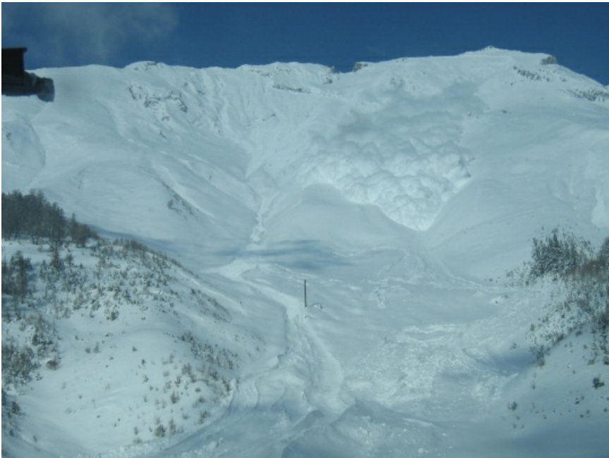
Künstlich ausgelöste Staublawine im SLF-Versuchsgelände Valle de la Sionne am Donnerstagvormittag, 17.02.2005, Sion, VS. Bild 2 von 3: Die Staubwolke hat sich im steilsten Bereich der Sturzbahn entwickelt.
