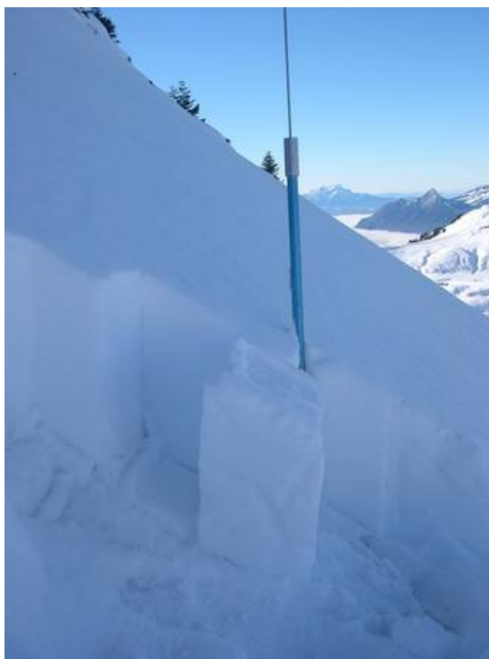
Photo 7: Profil de neige dans la région de Hoch Ybrig, pente exposée au nord, 34°, 1840 m. Toute la couverture neigeuse ne présente pas de tensions et est constituée de cristaux ayant subi une métamorphose constructive avec, au niveau du sol, des cristaux en gobelets d'une dimension allant jusqu'à 10 mm. En cas de neige fraîche, les zones qui n'ont pas encore été empruntées par les adeptes des sports d'hiver sont dangereuses. En arrière-plan, on peut voir au-dessus de la mer de brouillard le Pilatus et Rigi Hochflue (photo: ENA/B. Zweifel, 17.01.05).
